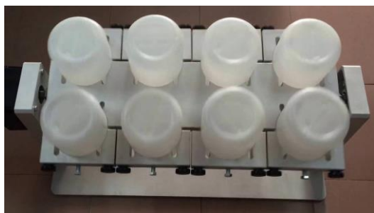
Σχήμα 2. Αναδευτήρας περιστροφικός 360ο – περιστροφή δοκιμών σε αναλογία υγρού στερεού 10 / 1 και ανάμειξη για 24 ώρες.
