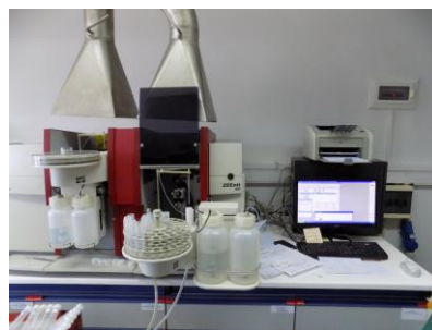
Σχήμα 3. Φούρνος γραφίτη που χρησιμοποιήθηκε. Analytik Jena Zeenit 700.
