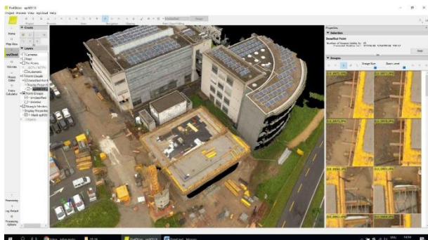
Εικόνα 4. Δεδομένα από MEEO drone με σκοπό τη μοντελοποίηση κτηριακών πληροφοριών
