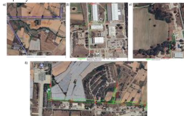
Εικόνα 1 Σχηματική απεικόνιση του προτεινόμενου συστήματος επαναχρησιμοποίησης των λυμάτων της Μονάδας.
