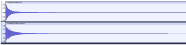
Εικόνα 2: Γενικές κυματομορφές πραγματικού - μοντέλου μεταλλόφωνου
